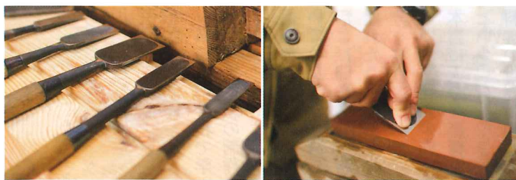
左／宮大工の仕事に欠かせないノミ。大小さまざまな種類を使い分け、木材を加工していく。 右／始業前や仕事の合間に道具の手入れを行う。上手く研げるようになるまでに相当の鍛錬が必要という。
